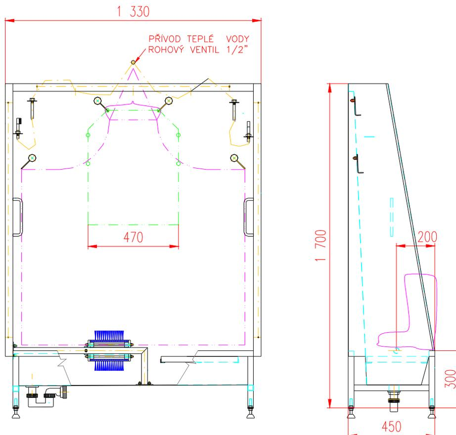
Установка предназначена для дезинфекции и очистки фартуков и обуви. Используется прежде всего в пищевой промышленности, в гигиенических зонах. Установка снабжена крючками для развешивания фартуков. Очистка обеспечивается при помощи душа и щётки с горячей водой. По желанию заказчика возможно поставить установку для мытья фартуков и подошв в комплекте. Установка из нержавеющей стали выполнена так, что отвечает всем санитарно-гигиеническим требованиям.
